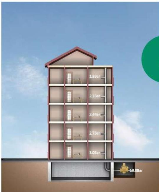
Para edificios igual o inferior a 5 plantas, la válvula reguladora de presión se puede instalar en la tubería de entrada principal o acometida. Esto genera un diferencial de presiones en cada una de las plantas. Si tomamos como ejemplo que cada planta es de 3m de altura, a medida que se suben plantas se reduce la presión en 0,3Bar.
